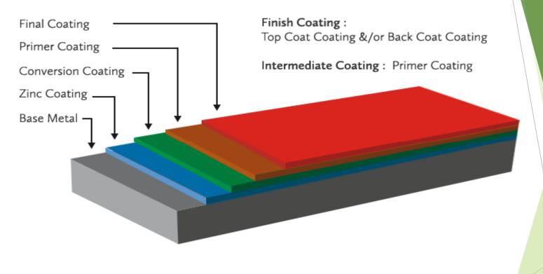
**COATING** TOP COAT **BOTTOM COAT** : 11 microns
